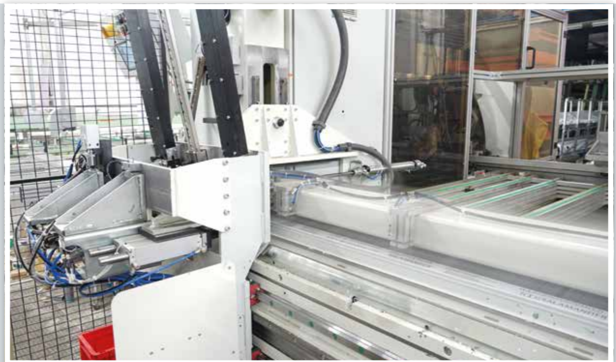
Station de pose et de vissage des gâches Puesto de colocación y atornillado de los cerraderos
