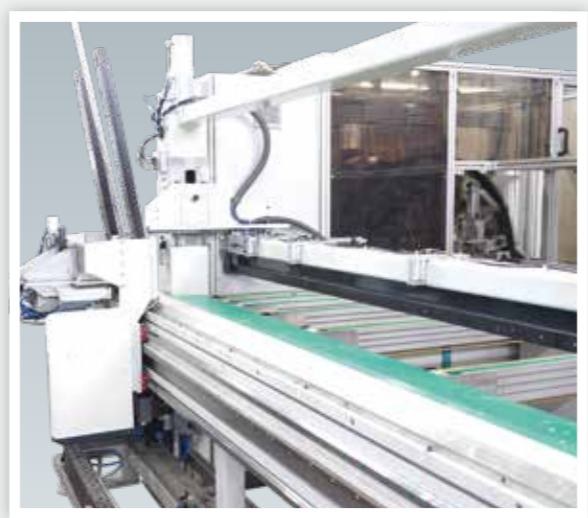
Station de pose et de vissage des gâches Puesto de colocación y atornillado de los cerraderos
