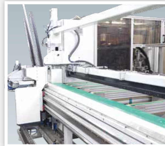
Schließteilsetz- und Schraubstation locking part positioning and drilling station
