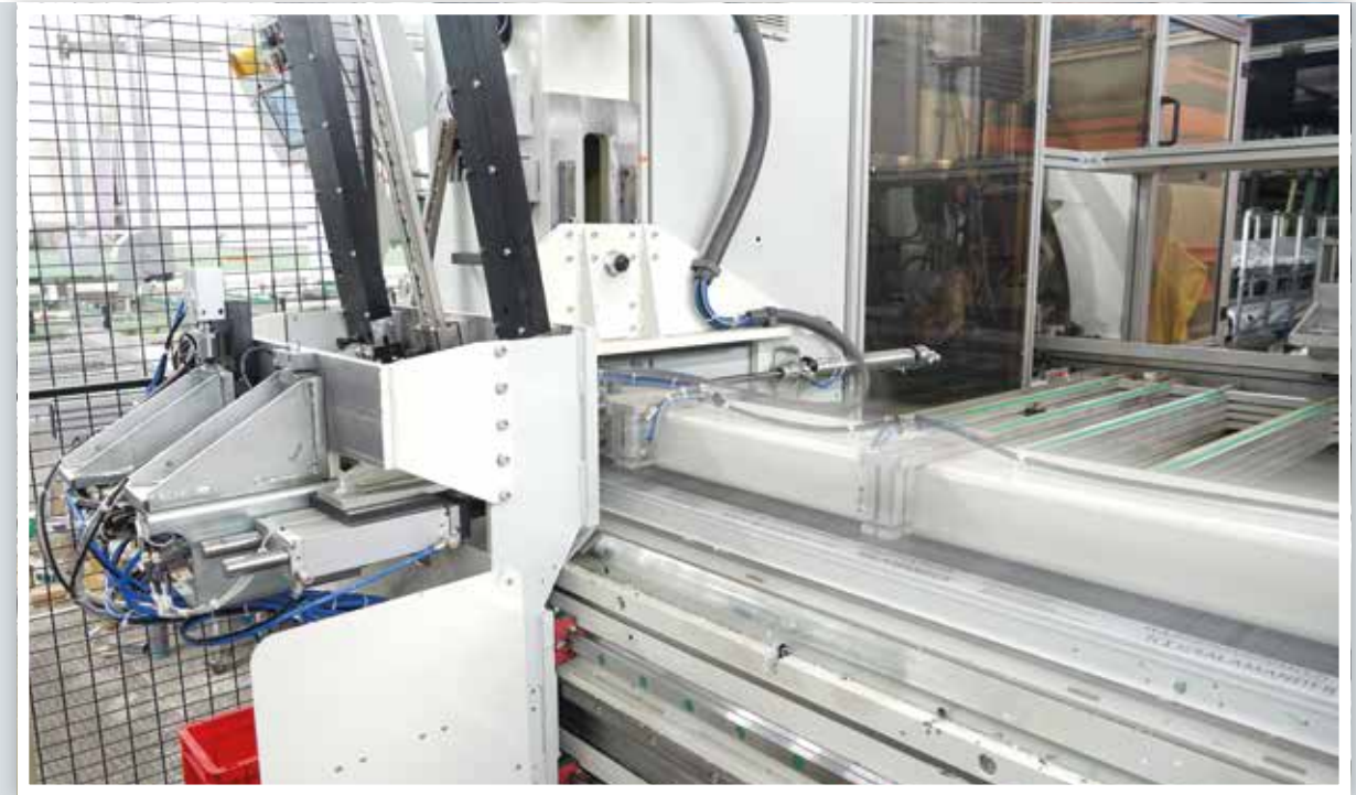
Schließteilsetz- und Schraubstation locking part positioning and drilling station
