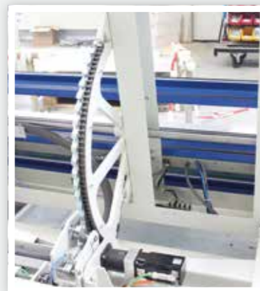
Gewichtsneutrales kippen des Tisches mittels Servomotor Weight neutral tilting of the table using servo motor
