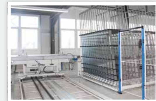
Antrieb der Pufferplätze mittels Fahrwagen Buffer slots driven by carriages
