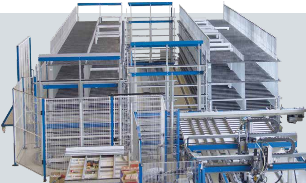
Antrieb der Pufferplätze mittels Fahrwagen Buffer slots driven by carriages
