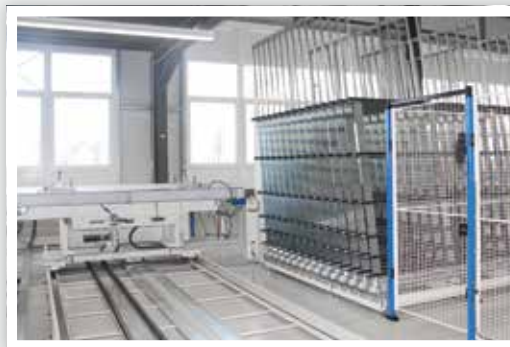
Antrieb der Pufferplätze mittels Fahrwagen Buffer slots driven by carriages
