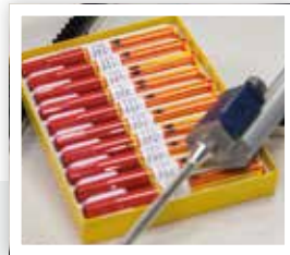
Возможно использование, опционально, автоматическое лакирование углов после их зачистки. Automatyczne lakierowanie po oczyszczeniu wypłytki zewnętrznej
