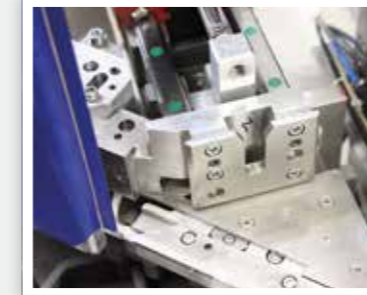
Zulagenwechsel ohne Werkzeuge changing of fixtures without tools
