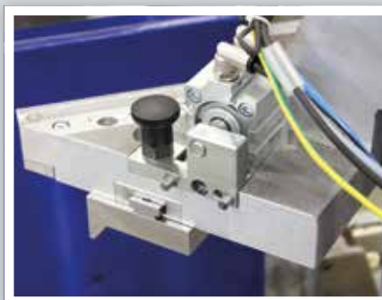
Ограничитель внутреннего угла Ograniczenie wypływki narożnika wewnętrznego
