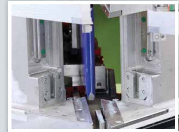
Смена цулаг без инструмента System wymiany podpór profilowych bez narzędzi
