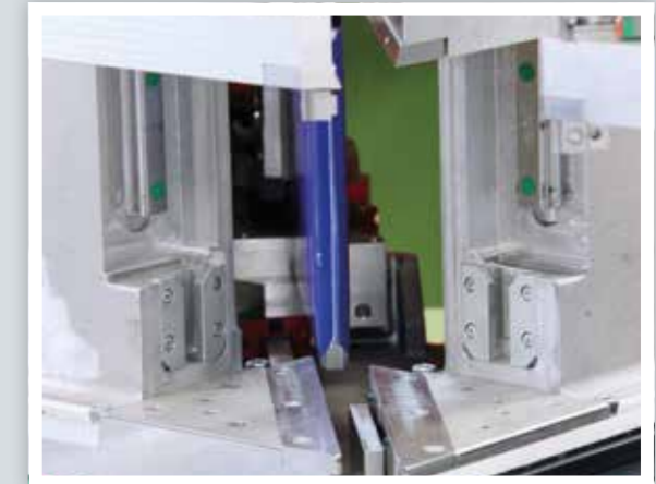
Zulagenwechsel ohne Werkzeuge changing of fixtures without tools
