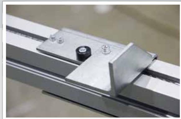
**Zum Herstellen der Schlosskastenfräsung im PVC-Profilstab und der Griffolivenbohrung auch in die Stahlverstärkung**
