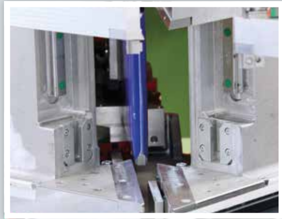
Zulagenwechsel ohne Werkzeuge changing of fixtures without tools
